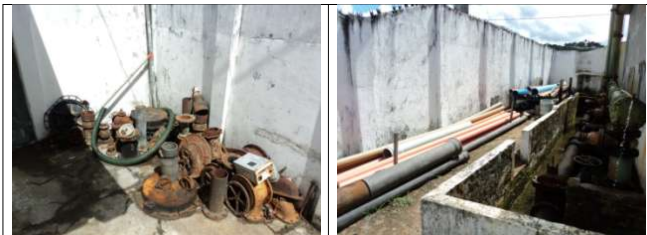
Figura 8.2 – Materiais e peças dispostos de forma inadequada
